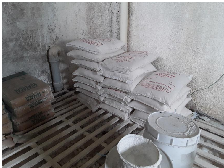
Figura 57 – Armazenamento da cal, sulfato de alumínio e hipoclorito de cálcio
