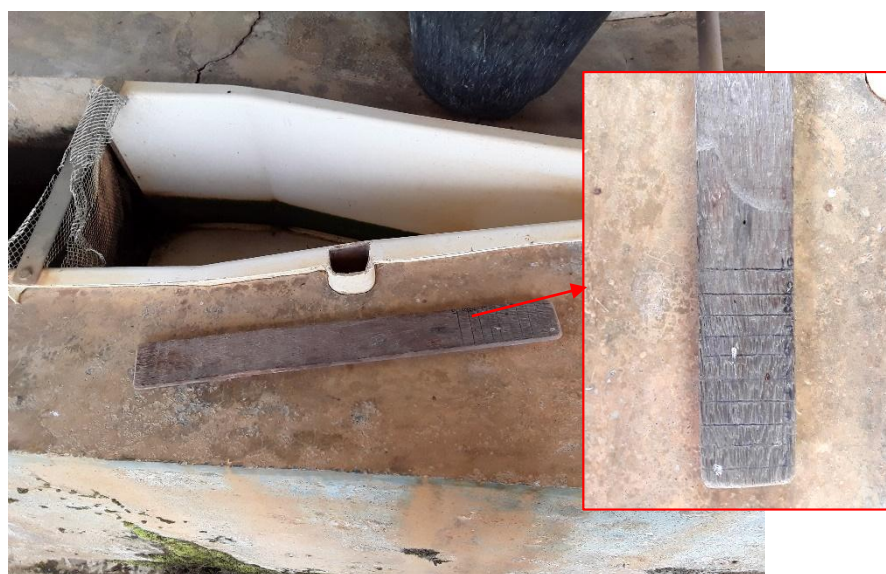
Figura 68 – Régua para medição de vazão
