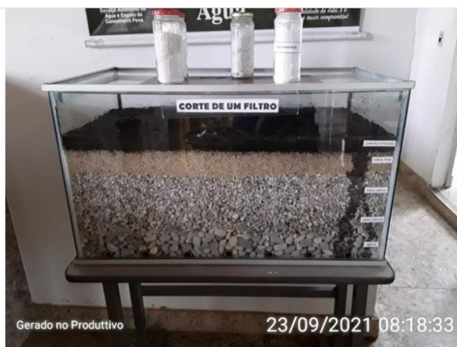
Imagem ilustrativa da composição do leito filtrante
