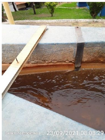
Régua utilizada para medição da vazão
