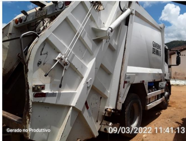
Caçamba fechada evitando a exposição dos RSU.
