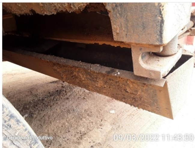
Calha coletora de chorume.
