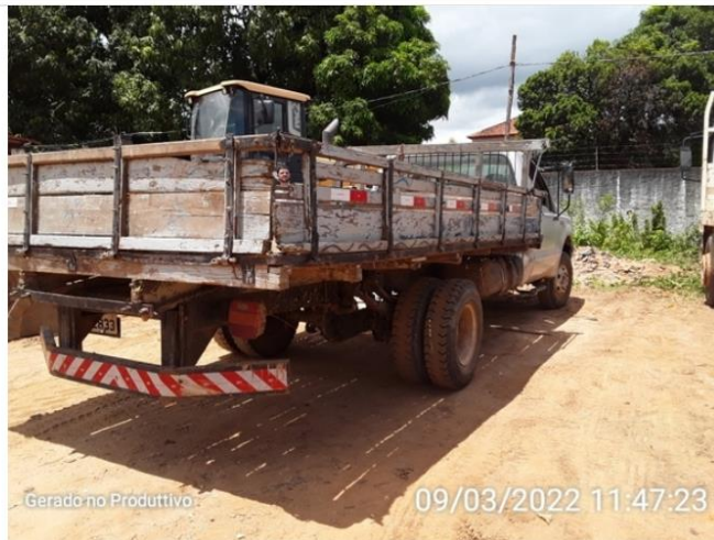
Ausência de calha para chorume.
