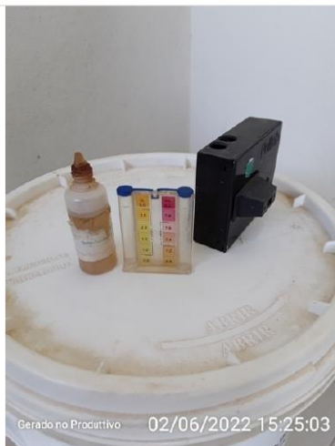
Equipamento usado para análise de cloro e pH
