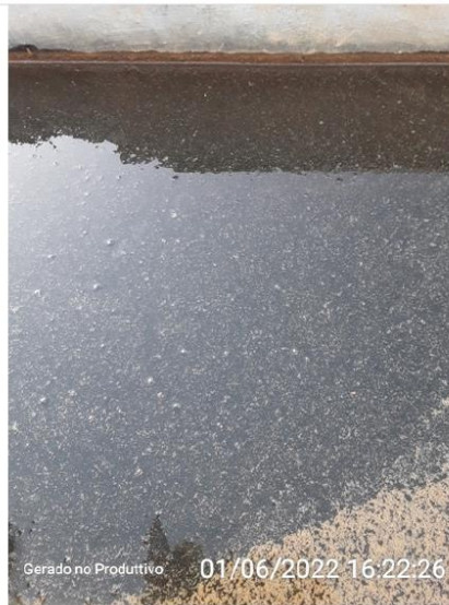
Formação de flocos no sistema circular.
