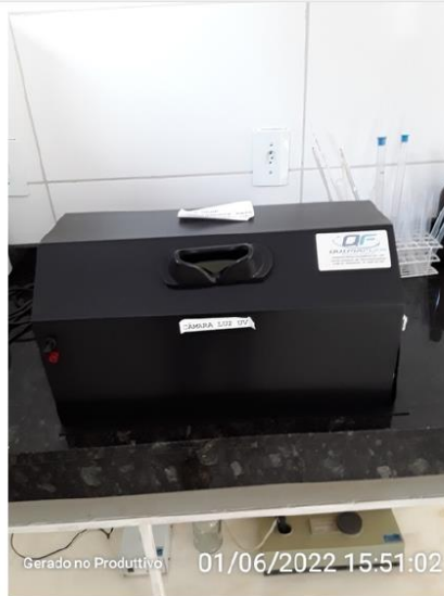
Câmara escura com transluminador UV.
