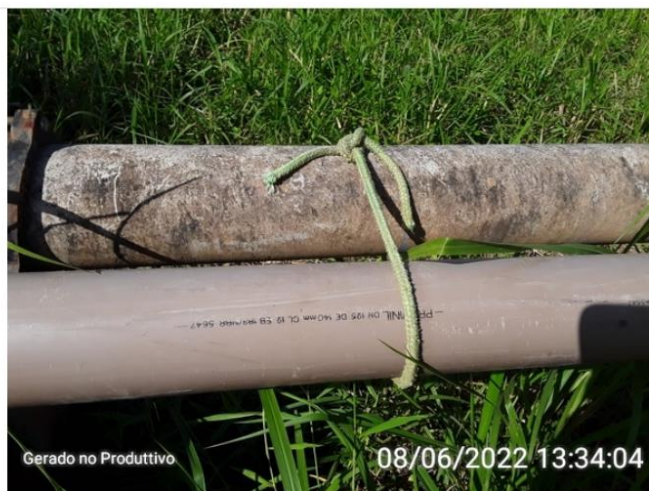
Tubo amianto e PVC
