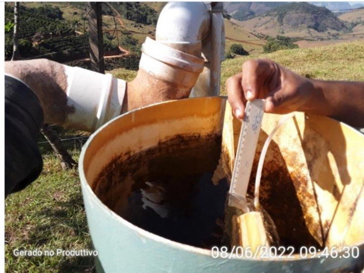
Procedimento para realizar a medição da vazão no vertedouro.
