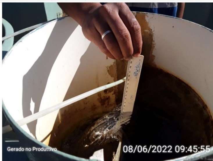
Régua milimetrada usada na medição de vazão.
