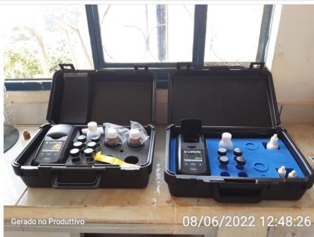
Medidor de Cloro e Turbidímetro digital em desuso e com bom estado de conservação.
