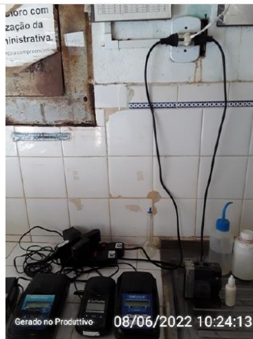
Vários aparelhos conectados em uma única tomada
