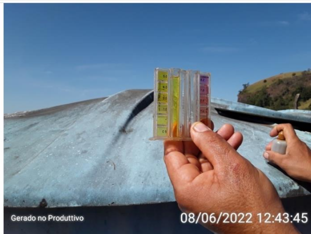
Teste de reagente de cloro residual livre feito pelo operador
