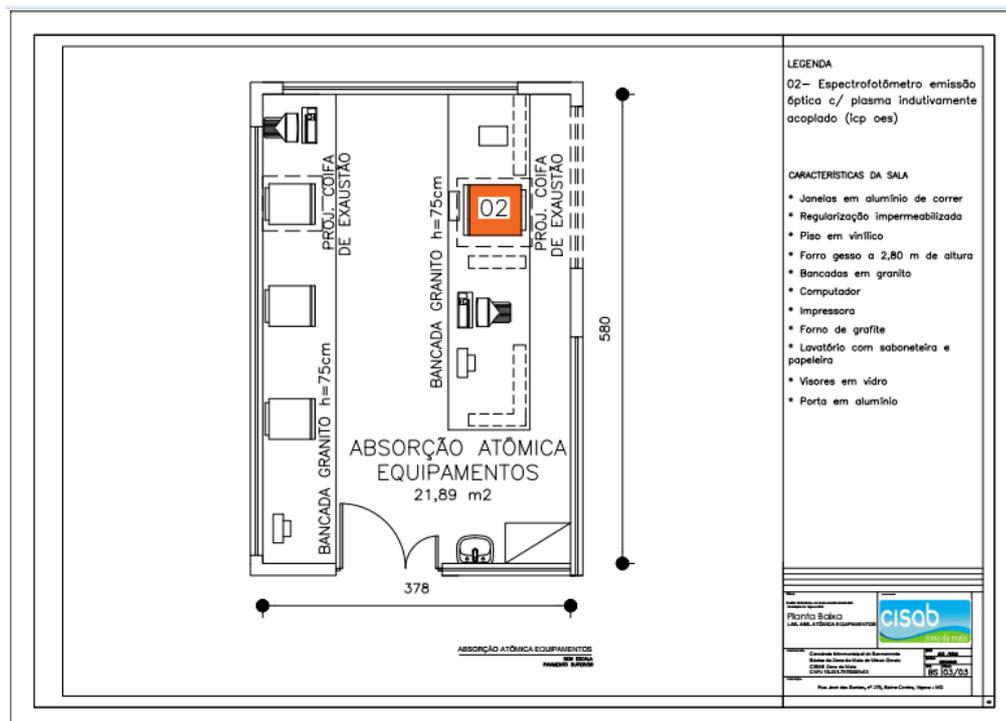
**Figura 2.** Planta baixa do laboratório de absorção atômica.
